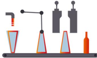
Preparado, luego se sopla en 2 etapas (un premolde y un molde terminado). El vidrio se moldea hasta su diseño final
